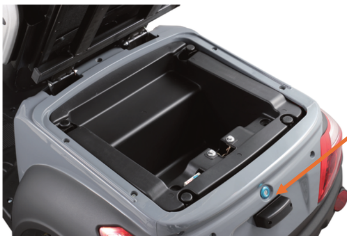
Fig. 1.10 Représentation schématique du mécanisme de verrouillage du siège
